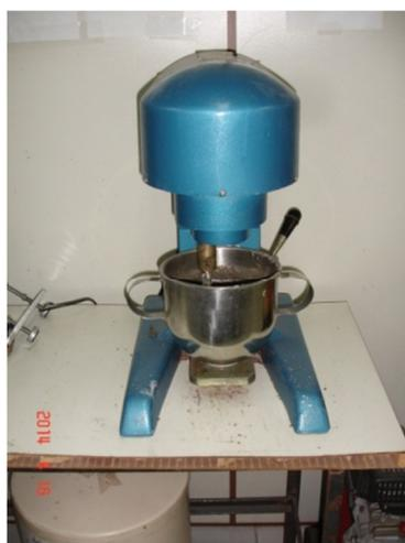
Figura 15 - Argamassadeira utilizada na produção das argamassas de revestimento.
