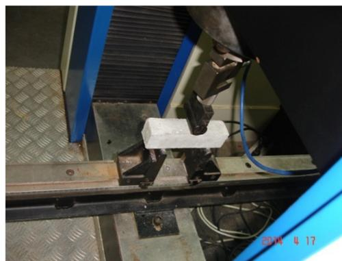
Figura 17 - Equipamento utilizado para o ensaio de resistência à tração na flexão.
