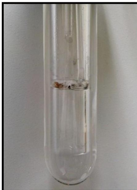
**Figura 11** – Aspecto da solução absorvedora e do sistema de decomposição após a decomposição de 400 mg de polímero por MIC, com 50 µl NH<sub>4</sub>NO<sub>3</sub> 6 mol l<sup>-1</sup> e pressão de O<sub>2</sub> de 20 atm.
