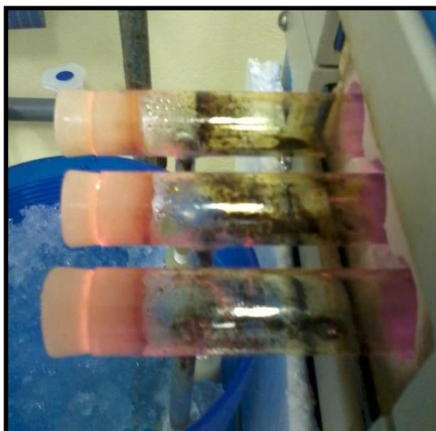
**Figura 18** – Imagem da saída do reator, onde pode ser observada a adsorção de material (condições de piroidrólise: tempo de reação 10 min; massa de amostra 300 mg; temperatura 1000 °C).
