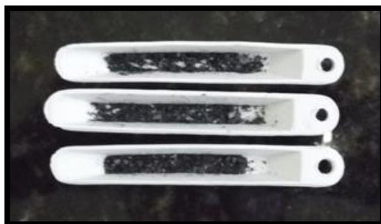
**Figura 16** – Suporte de cerâmica utilizado no sistema de piroidrólise, contendo amostras de polímero antes da decomposição.
