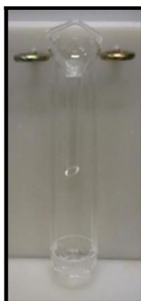
**Figura 5** – Dispositivo de quartzo utilizado na MIC como suporte para as amostras.
