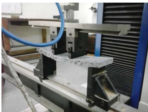
Figura 23 - Ensaio de flexão a quatro pontos.
