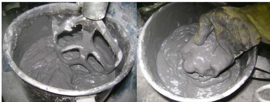
Figura 19 - Inserção de água e aditivo com mistura por dois minutos para obtenção de uma pasta com textura plástica e homogênea e inserção das fibras de PP com mistura por 5 minutos.
