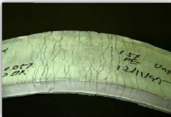
Figura 39 - Aspecto de um padrão de fissuração de um compósito de ECC
