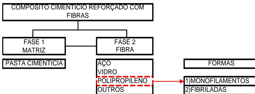
Figura 3 - Esquema de distribuição das fases que compõem os compósitos reforçados com fibras.
