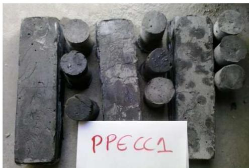
Figura 22 - Desmoldagem após 24 horas para posterior cura em tanque de água até serem submetidos aos ensaios.
