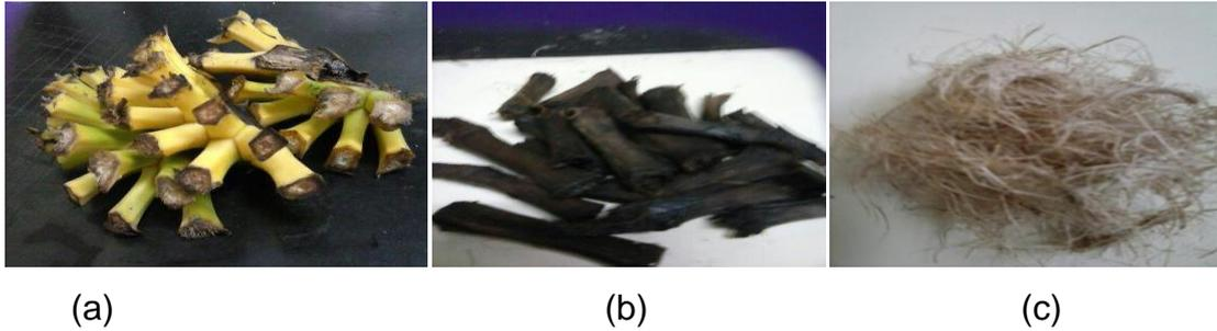
Figura 10 - Talos de banana (a) in natura; (b) sem película; (c) autoclavados.
