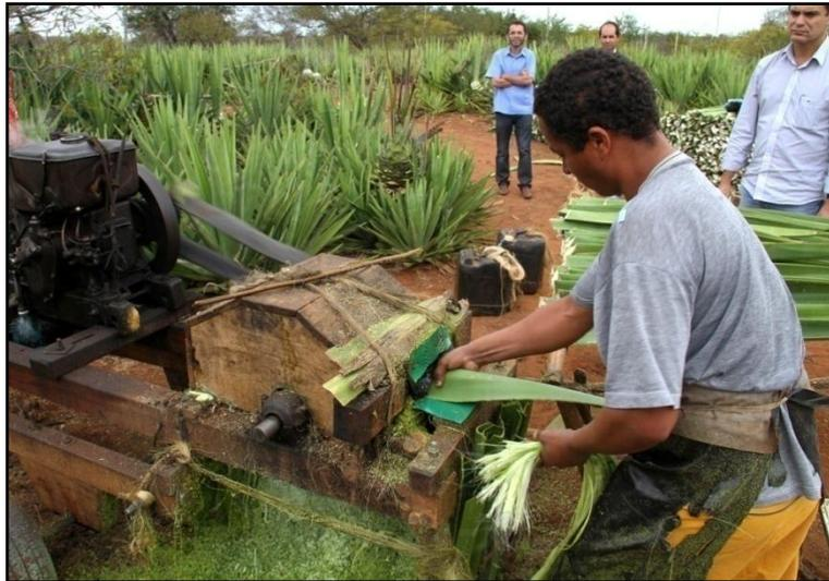
Figura 3 - Desfibrador usado no processo de extração da fibra de sisal.
