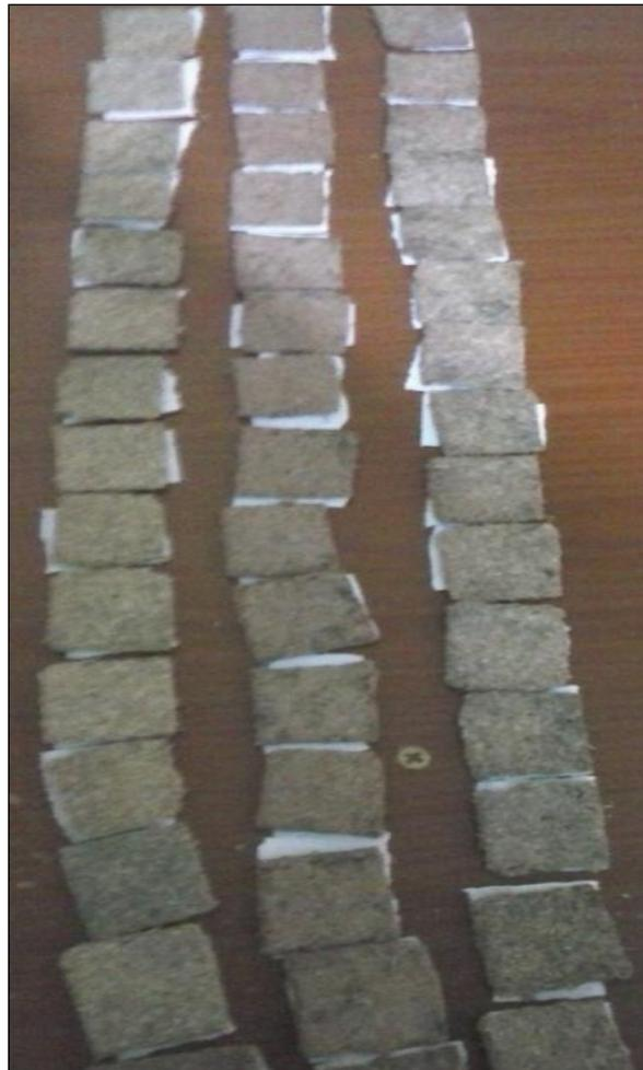
Figura 14 - Corpos de provas utilizados na análise de biodegradabilidade dos corpos de prova dos compósitos F1, F2 e F3 em solo simulado.
