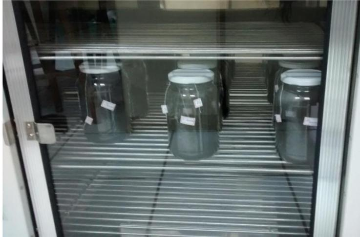
Figura 16 - Corpos de prova nos frascos tampados colocados em estufa.
