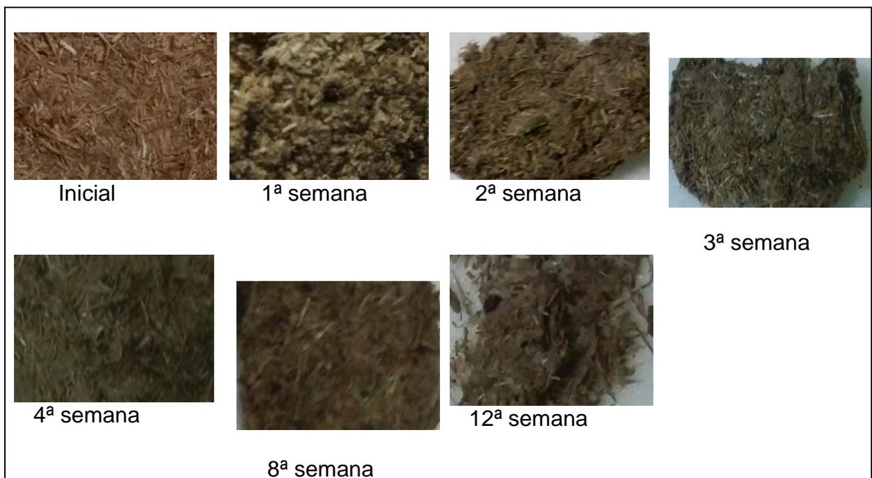
Figura 23 - Imagens fotográficas da biodegradação do compósito F2 (fibras do talo da banana + PVA).
