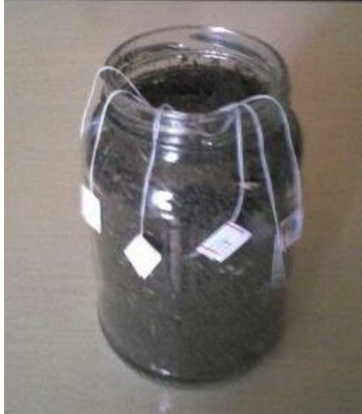
Figura 17 - Teste de biodegradabilidade do ligante a base de PVA em solo simulado
