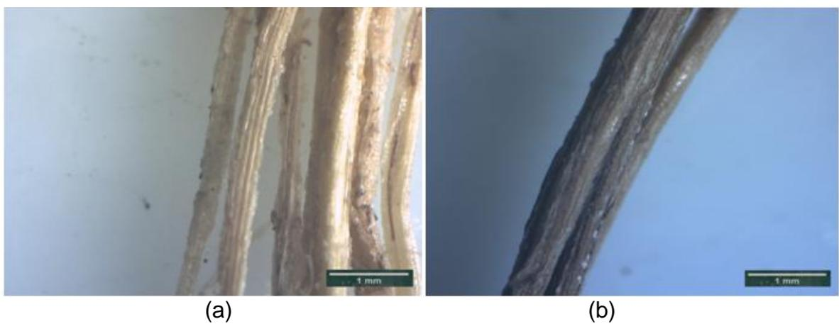
Figura 18 - Micrografias por MO das fibras vegetais extraídas da rama da bata doce (a) e do talo da banana (b) com aumento de 20x.
