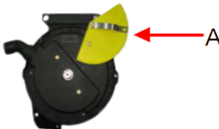
Figura 34. Detalhes construtivos do dosador Matermacc, onde: (A) Regulação do exclusor de sementes.
