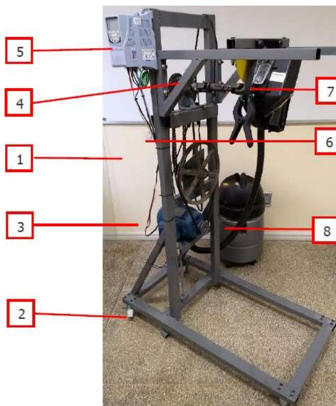
Figura 11. Bancada de ensaios equipada com dosador pneumático, onde: 1) Estrutura da bancada; 2) Rodas de mobilidade; 3) Motor elétrico; 4) Eixo árvore cardã do sistema de transmissão; 5) Inversor de frequência; 6) Sistema de transmissão; 7) Dosador de sementes pneumático; 8) Aspirador de pó (fonte de vácuo).
