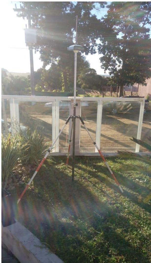
Figura 5 – Base GNSS RTK (- 31° 00' 01,0388"; -52° 02' 42,1055").
