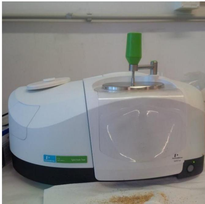
Figura 12 – Equipamento para espectroscopia no infravermelho por transformada de Fourier empregado na análise química qualitativa.
