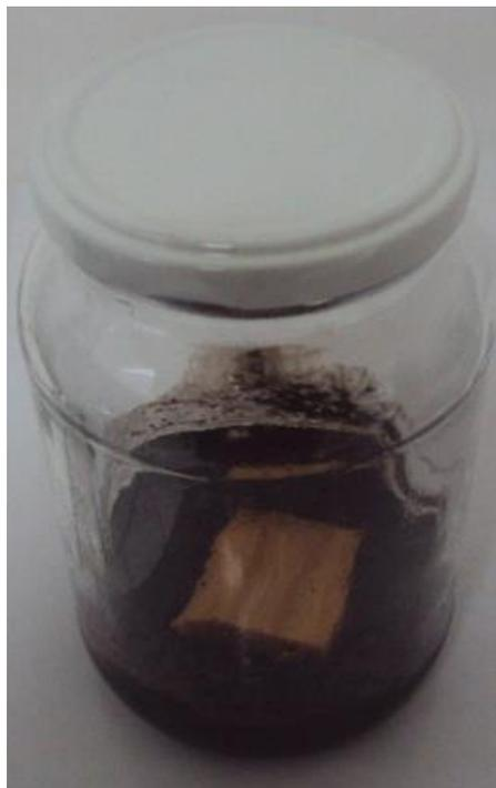
Figura 10 – Frasco com solo e placa suporte utilizados no experimento de apodrecimento acelerado.
