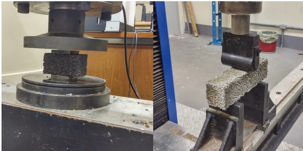
Figura 8 – Ensaio de compressão e resistência a tração na flexão realizados em laboratório.
