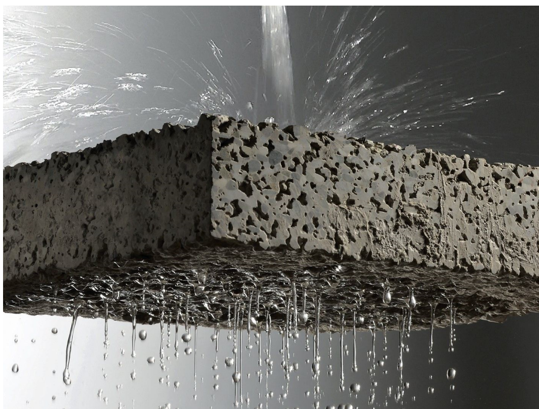
Figura 1 – Exemplo de Blocos de argamassa permeável.
