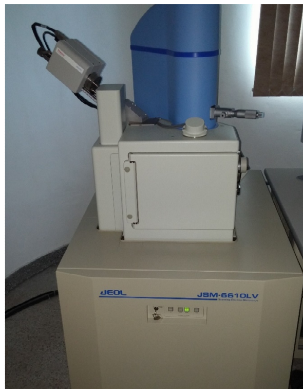
Figura 11 – Microscópio eletrônico de varredura acoplado ao computador.
