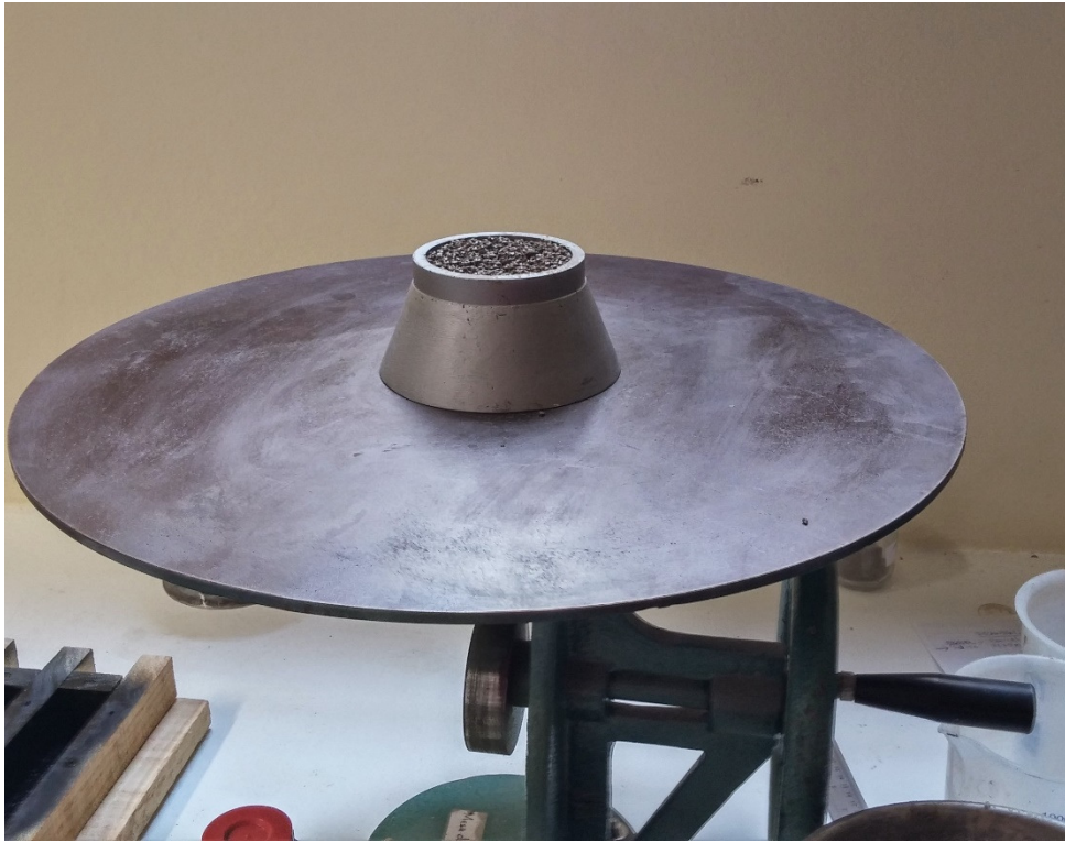
Figura 7 – Mesa para a determinação do índice de consistência no estado fresco.
