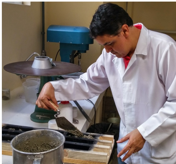
Figura 9 – Disposição da argamassa em formas de acordo com a norma.
