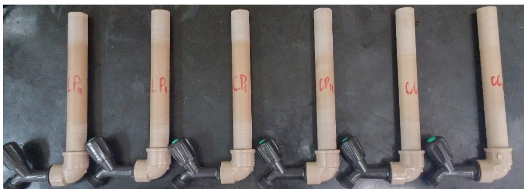
Figura 14 - Corpos filtrantes no instante de montagem para a coleta e filtragem da água.
