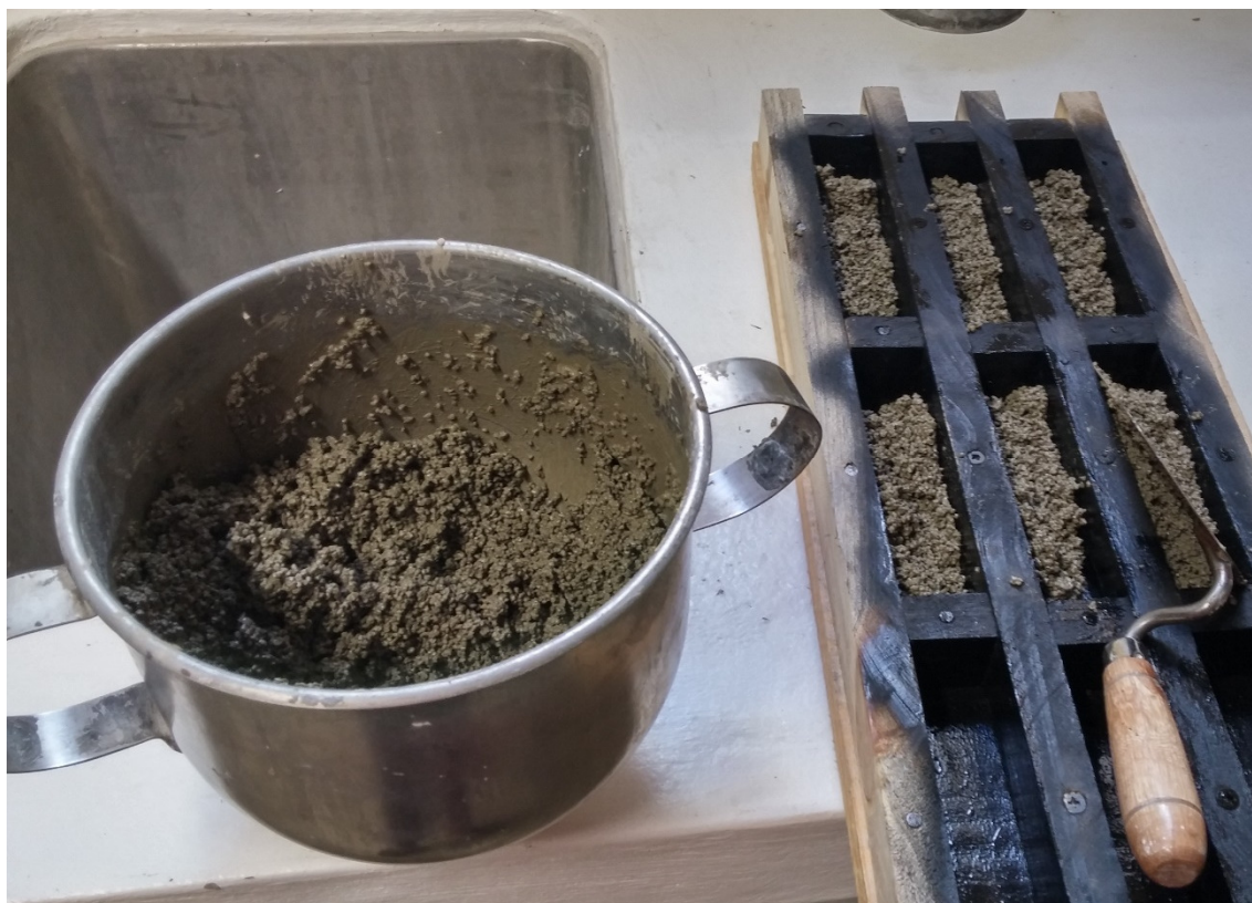
Figura 6 – Mistura das composições no recipiente da argamassadeira.
