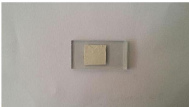
Figura 22: Foto-eletrodo obtido pela técnica *Doctor-Blade*
