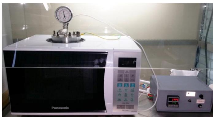
Figura 17: Sistema usado para o método hidrotermal assistido por micro-ondas (HAM), (adaptado).
