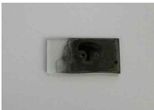
Figura 24: Contra-eletrodo de platina em substrato de FTO.
