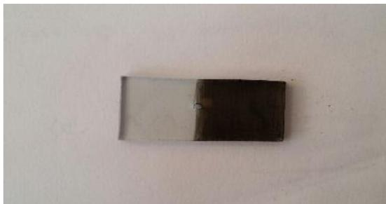
Figura 23: Contra-eletrodo de carbono (grafite) em substrato de FTO.
