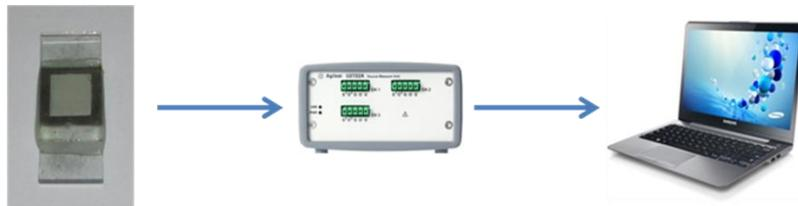
Figura 32: Sistema de medição simplificado, com a SMU U2702 da *Keysight*, para obtenção das curvas  $J$  Vs.  $V$  no escuro.
