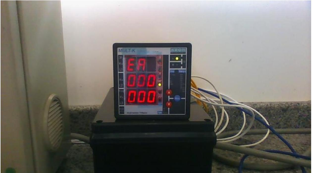
Figura 2.2. Leitor de energia Mult-K da Kron
