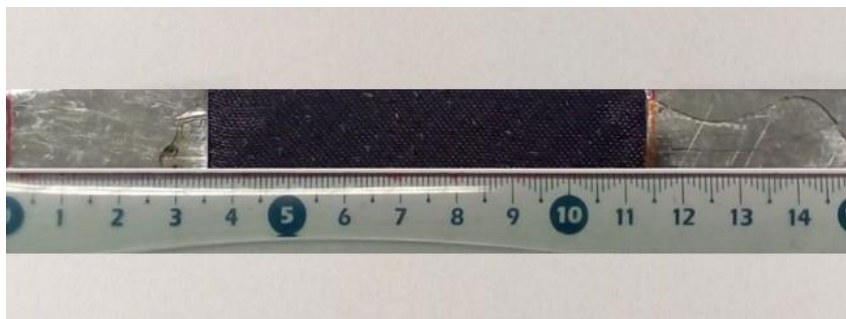
Figura 18: Corpo de prova utilizado nos ensaios de tração Fonte: imagem própria
