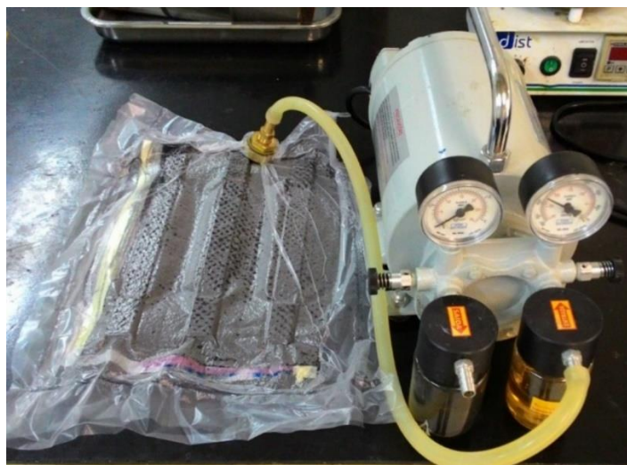
Figura 16: Processo de laminação do compósito com auxílio da compressão por vácuo Fonte: Imagem própria.
