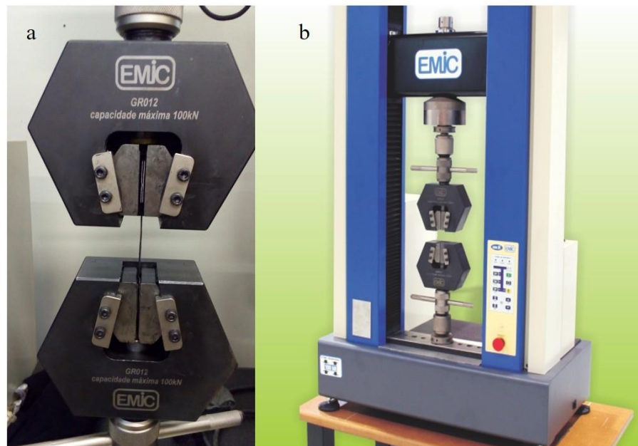
Figura 17: Ensaio mecânicos (a) Ensaio de Tração e (b) Máquina de ensaios universal EMIC - DL 10000 Fonte: (a) Imagem própria e (b) EMIC – www.emic.com.br
