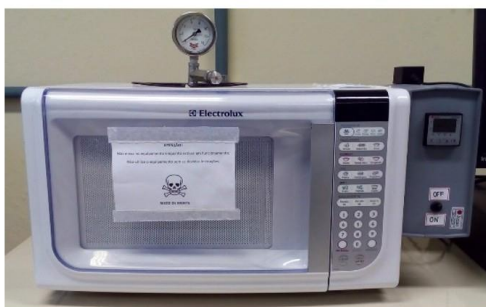
Figura 10: Micro-ondas adaptado utilizado para síntese hidrotermal dos nanotubos de carbono recobertos com ZnS Fonte: Imagem própria.
