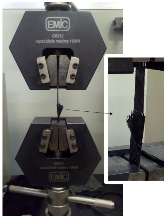
Figura 28: Ensaio de tração dos compósitos laminados com fibra de carbono, focando no rompimento de um corpo de prova.
