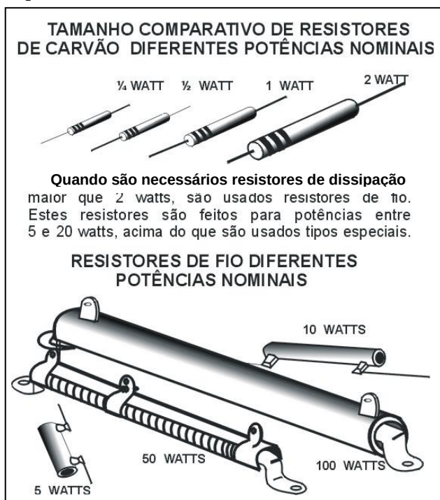
Fig.6.6 – Alguns resistores com suas potências nominais
