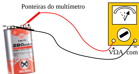
Fig.3.10 – Voltímetro: Medição de tensão CC
