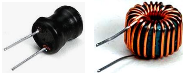
Fig.13.10 – Indutores comerciais: a) De carretel b) Toroidal
