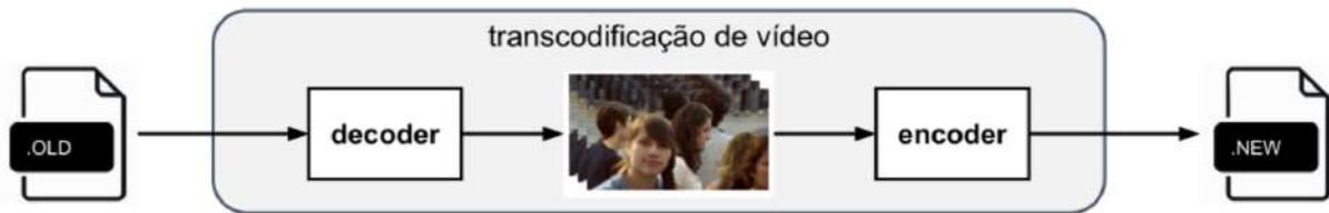
Figura 3 – Visão em alto nível de um transcodificador de vídeo original. Fonte: Elaborada pelo autor.
