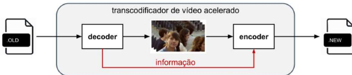
Figura 5 – Representação em alto nível de uma transcodificação rápida de vídeo. Fonte: Elaborada pelo autor.
