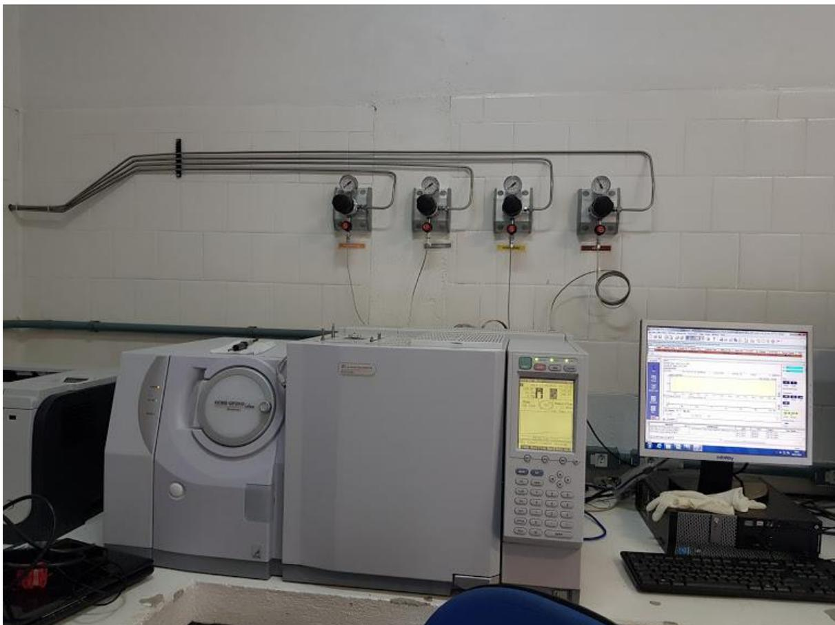
Figura 3 - Cromatógrafo a gás acoplado com espectrômetro de massas, utilizado para a determinação de compostos voláteis dos vinhos espumantes
