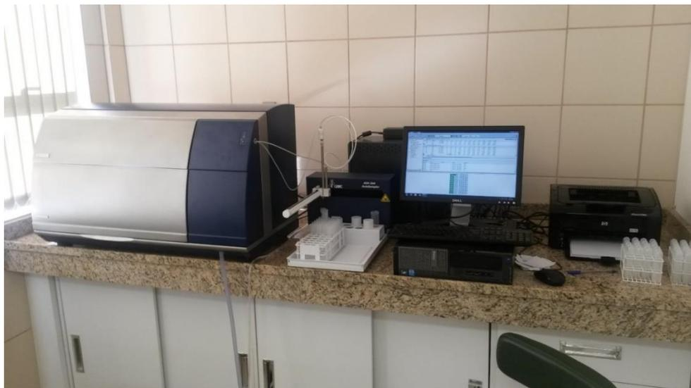
Figura 2 - Equipamento WineScan SO<sub>2</sub> (Foss Analytics, Hylleroed, Dinamarca), utilizado para as análises físico-químicas dos vinhos espumantes
