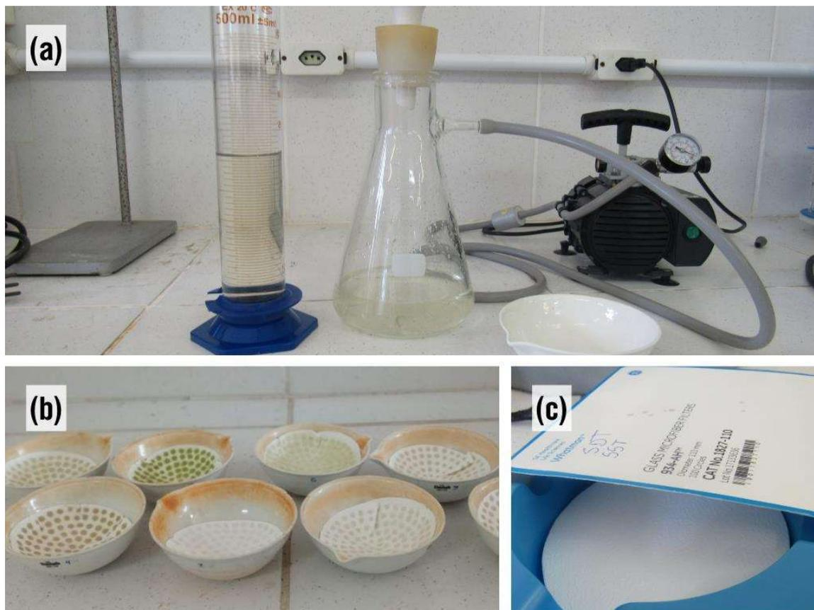
Figura 15 – (a) Etapa de filtração, (b) filtros utilizados e (c) resultado pós secagem na análise de SST. Fonte: Arquivo pessoal.
