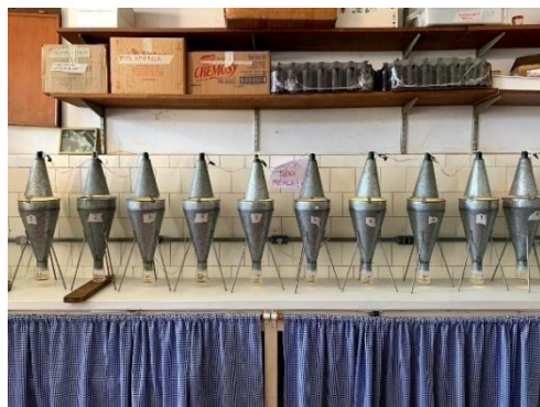
Figura 2: Amostras dispostas nos Funis extratores de Tullgren, no laboratório de biologia do solo da FAEM/UFPEL. Fonte: FERNANDEZ (2022).
