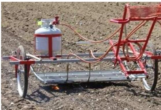
Figura 12 - Mecanismo de tração humana utilizado para aplicação de calor.
