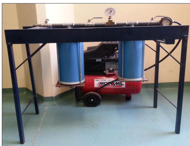
Colaboração no desenvolvimento de um picnômetro a ar para medir a porosidade de grãos
