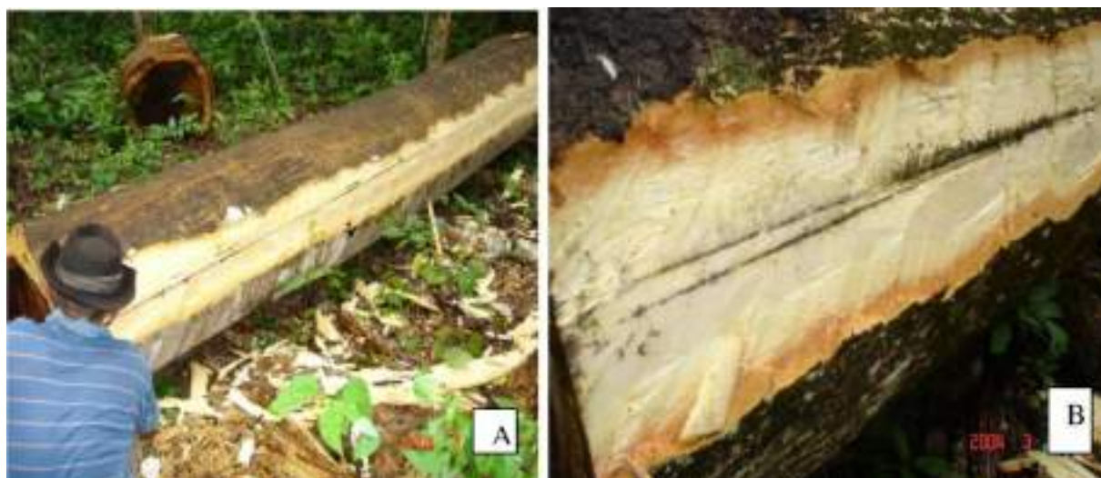
Figura 186 - 6 (seis) linhas de arrasamento e de levantamento da popa e da proa.
