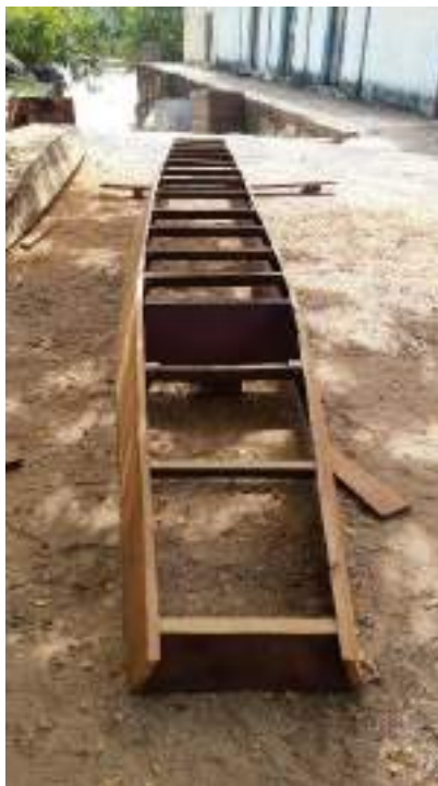
Figura 233 - Canoa de tábuas de Lourenço construída em maio de 2022. Estrutura armada. Colônia Z-2 às margens do Rio Paraguai Fonte: Acervo do autor, 18 mai. 2022
