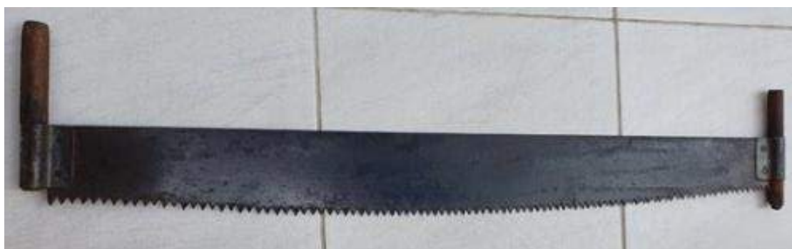
Figura 229 - Traçador, ferramenta para corte Fonte: Google
