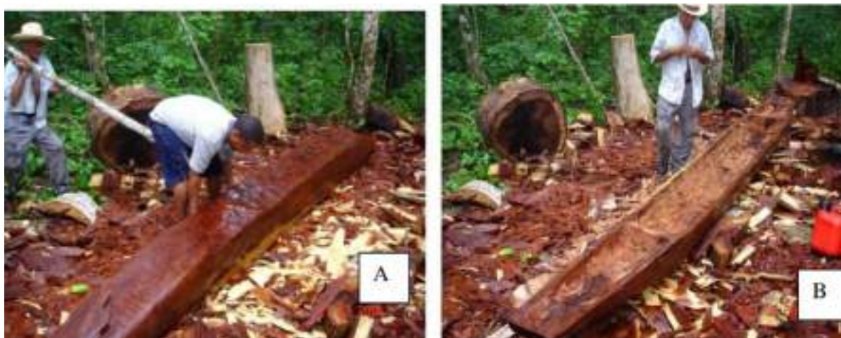
Figura 203 - Finalização da limpeza na mata - viração (esq.), preparação e limpeza da canoa (dir.). Fonte: Victorino (2013 [2006])
