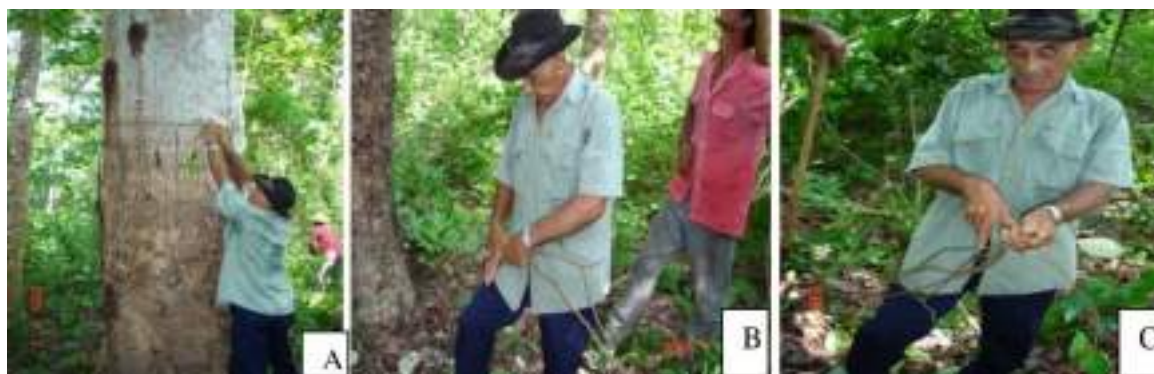
Figura 180 - Canoa monóxila - Medição com cipó; marcação no cipó e medida do palmo; dobra do cipó quatro vezes e estabelecimento da largura da boca da canoa. Fonte: Victorino (2013 [2006])
