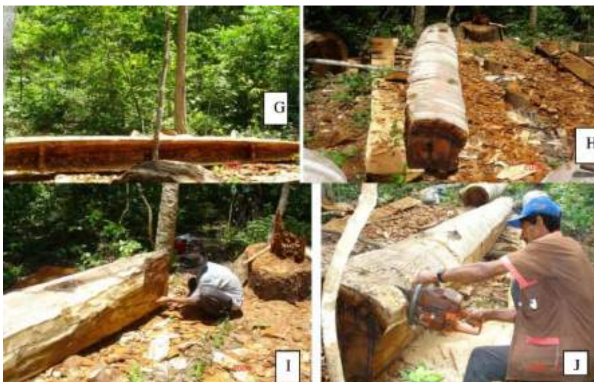
Figura 201 - Outro ângulo da viração, viração, bateção de linha para levantamento da proa e popa, talhamento do fundo com motosserra.
