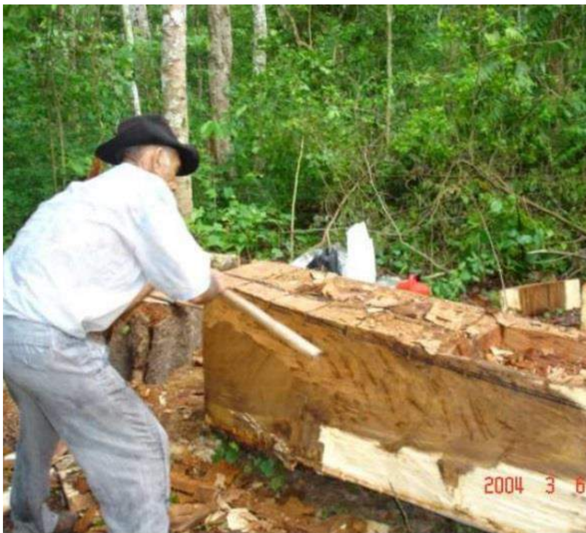
Figura 197 - Correção dos defeitos decorrentes do uso da motosserra com machado. Fonte: Victorino (2013 [2006])
