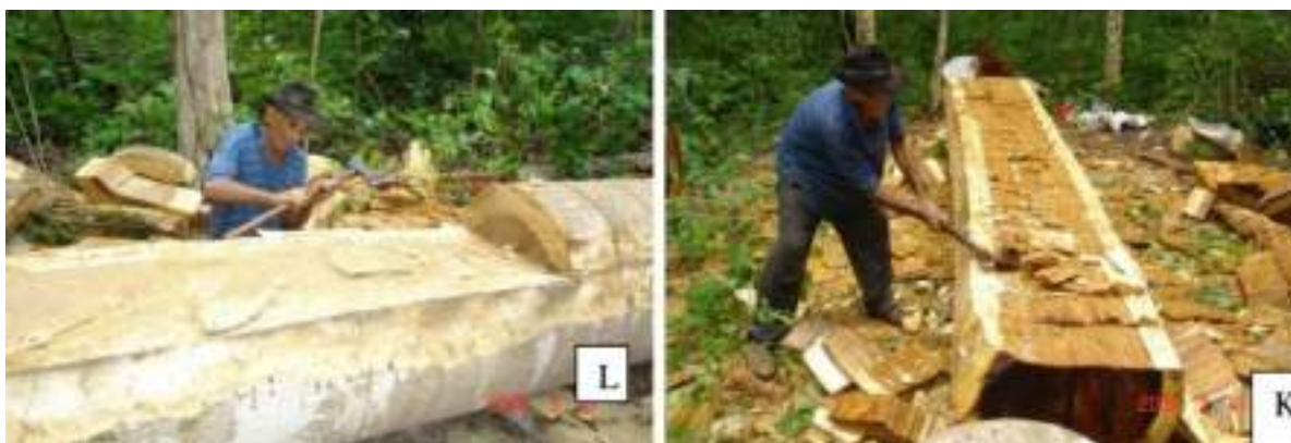
Figura 190 - Continuidade e finalização do talhamento superior com machado Fonte: Victorino (2013 [2006])
