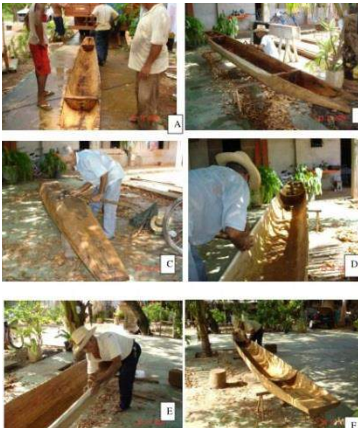
Figura 205 - Transfência da canoa para acabamento – a) transferência da canoa, b) limpeza interna, c) limpeza final do fundo, d) limpeza das laterais com cipio, e) limpeza das laterais com cipio, f) acabamento geral.
