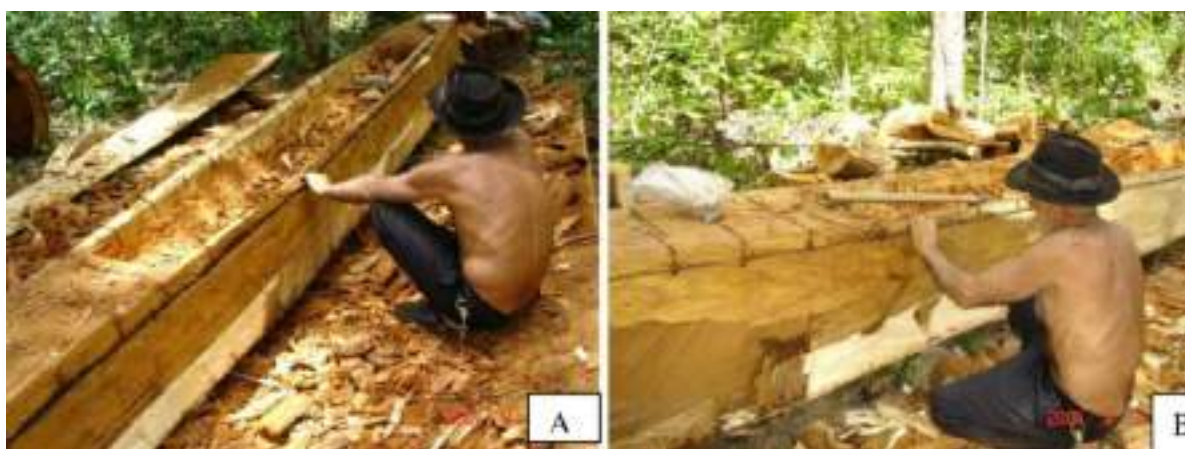
Figura 196 - Correção dos defeitos decorrentes do uso da motoserra. Análise das laterais (esq.); bateção de linha corretiva (dir.) Fonte: Victorino (2013 [2006])
