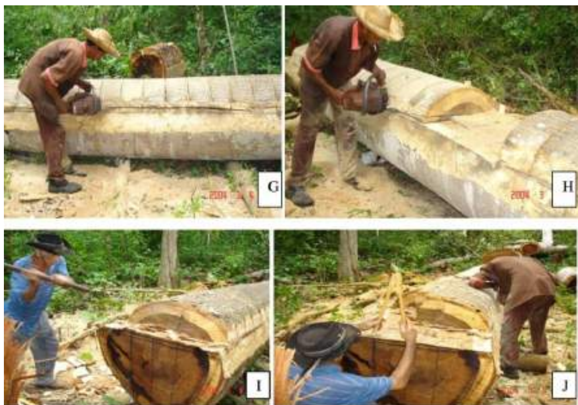
Figura 189 - Talhamento com motosserra (g); continuidade no talhar (h); uso do machado no talhamento (i); confirmação das medidas com compasso (j) Fonte: Victorino (2013 [2006])
