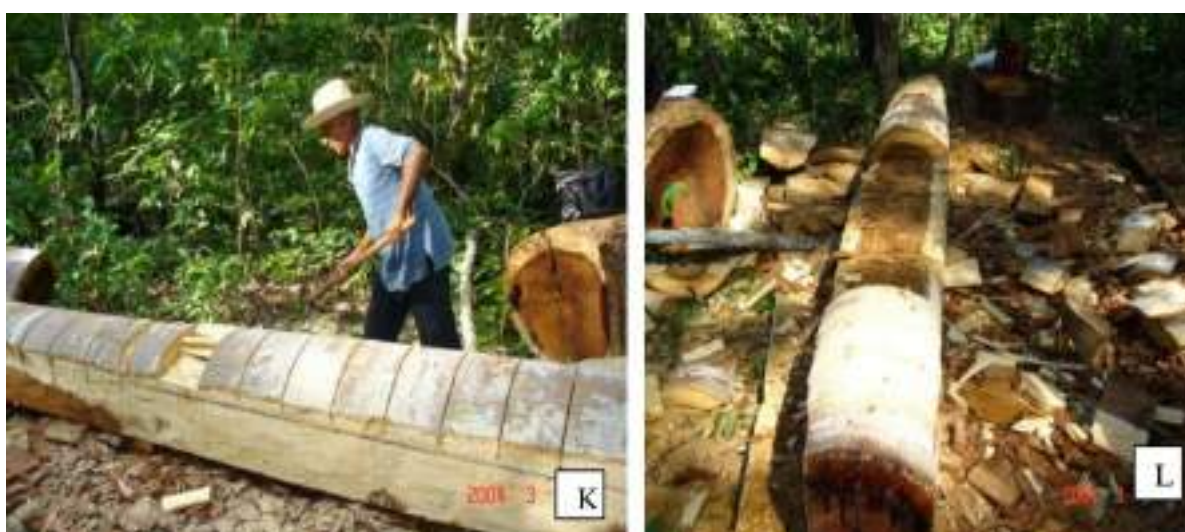
Figura 202 - Talhamento com machado (esq.), talhamento do fundo (dir.).
