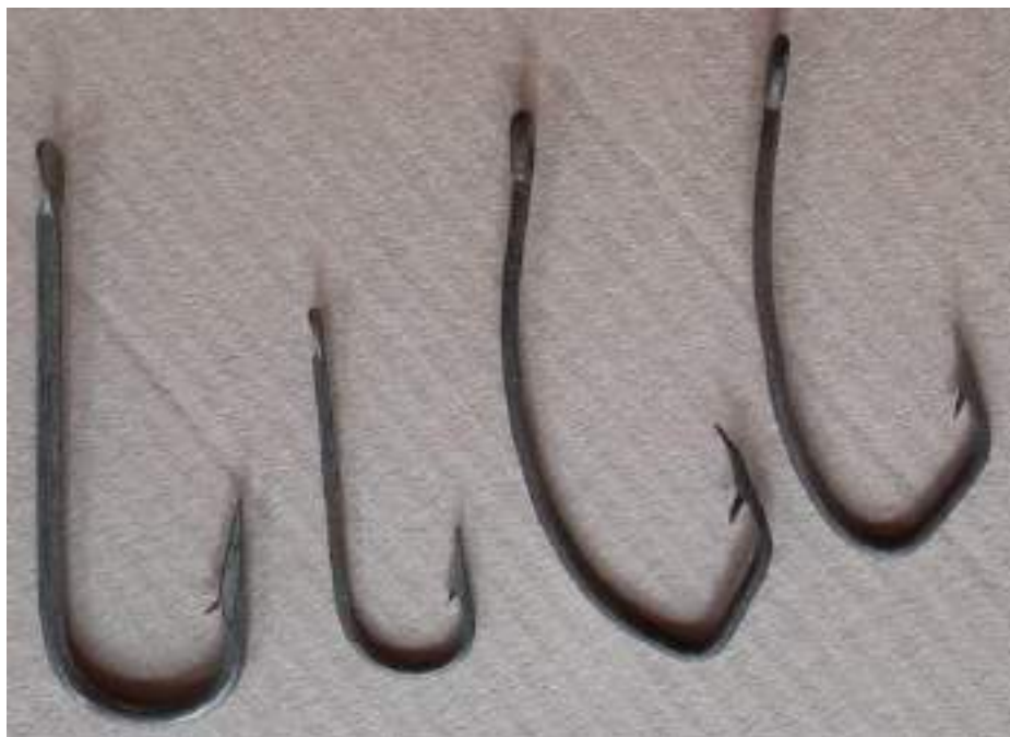
Figura 328 - Anzóis de pata (industrializados) e anzóis artesanais. Anzóis industrializados (os dois da esq.); os últimos dois anzóis confeccionados por Maria Severina há 35 anos (os dois da dir.) Fonte: Acervo de Lourenço Pereira Leite, 11 fev. 2023
