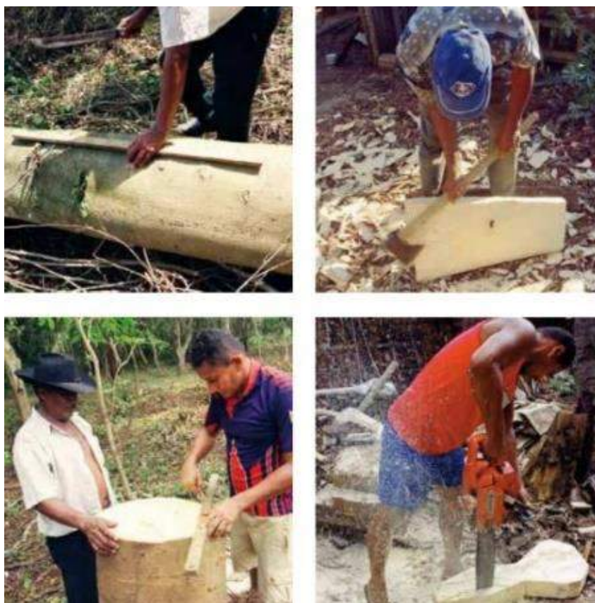
Figura 253 - Medida do corte (esq.); corte da madeira com machado e modelagem com motosserra (dir.). Fonte: IPHAN (2009)
