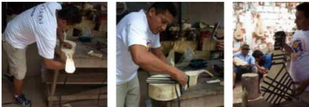
Figura 257 - Viola de cocho – preparação, colagem e fixação do tampo. Fonte: IPHAN (2009)
