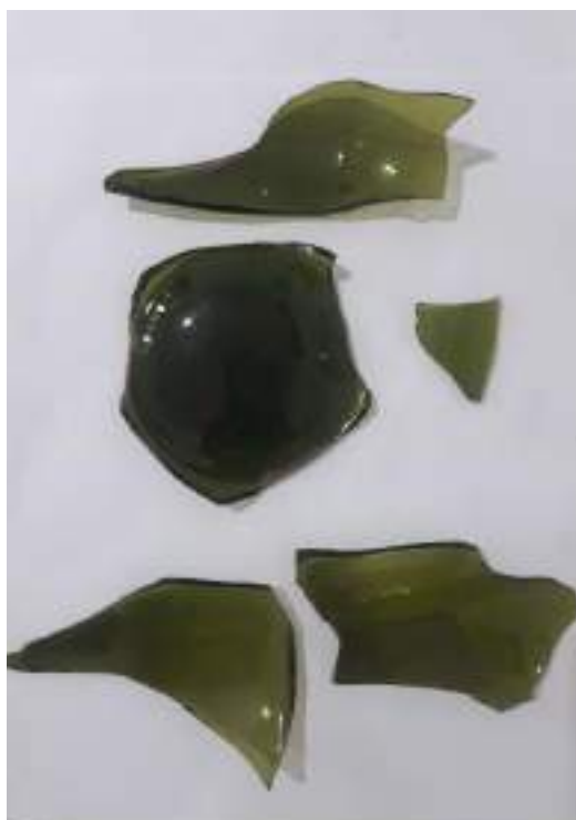
Figura 222 - Parte do conjunto de cacos de vidro usados para alisar o remo Fonte: Acervo do autor, 31 jan. 2023
