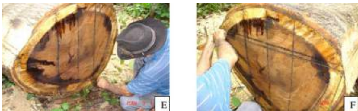
Figura 188 - Dez (10) linhas - centro/prumo, arrasamento e levantamento da popa e da proa. Fonte: Victorino (2013 [2006])
