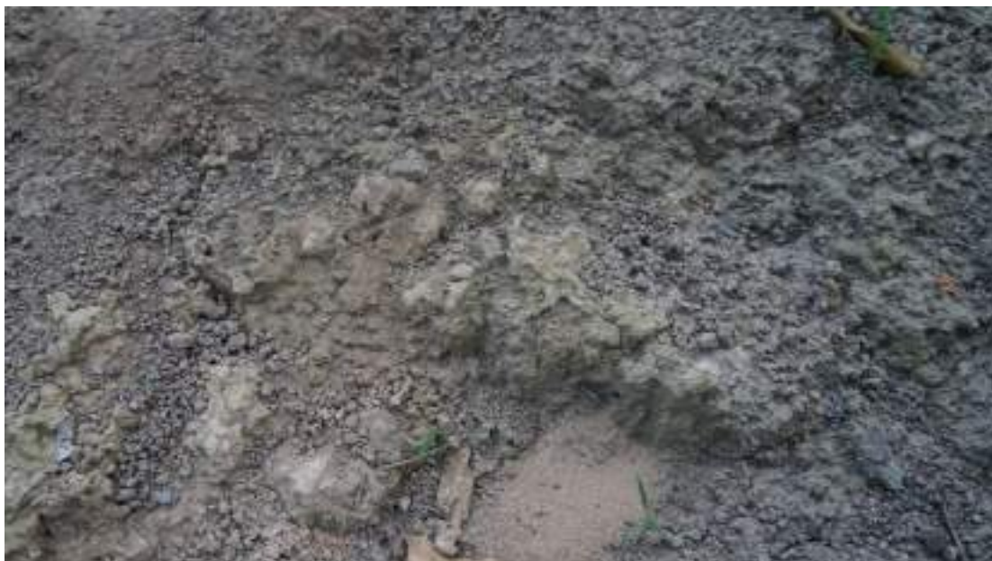
Figura 118 - Aterro do Sr. Zé da Barra, cupinzeiro compactado. Margens do Rio Paraguai. Fonte: Acervo do autor, 22 abr. 2022
