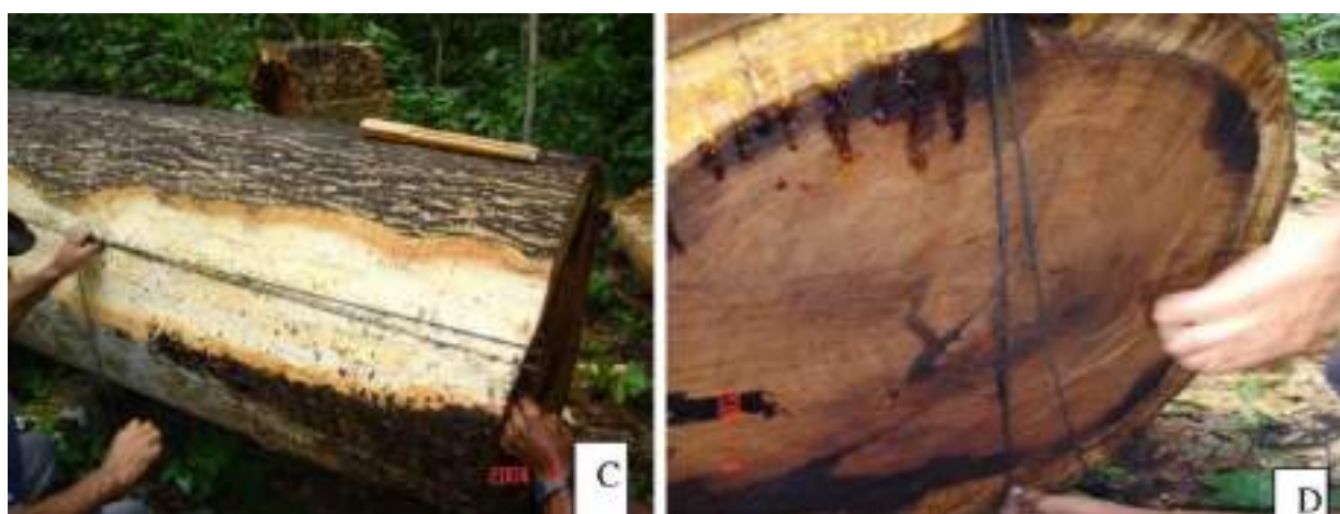
Figura 187 - Linhas para o levantamento de popa e proa (esq.); linha prumo ou centro da canoa (dir.).
