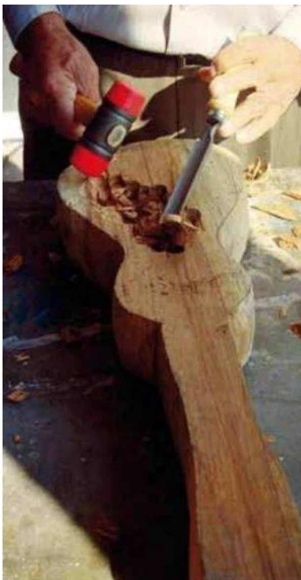
Figura 255 - Viola de cocho - escavação Fonte: IPHAN (2009)
