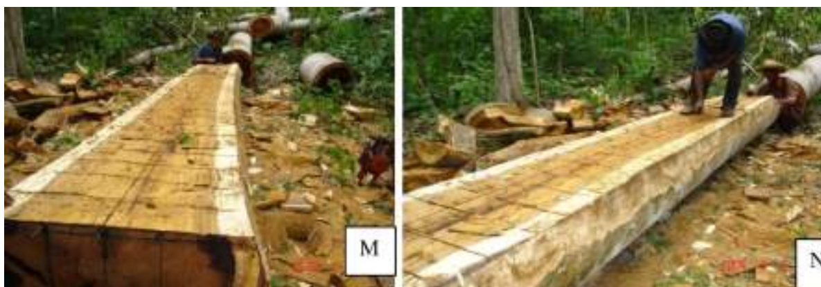
Figura 191 - Preparação (esq.) e bateção da linha de centro (dir.). Fonte: Victorino (2013 [2006])
