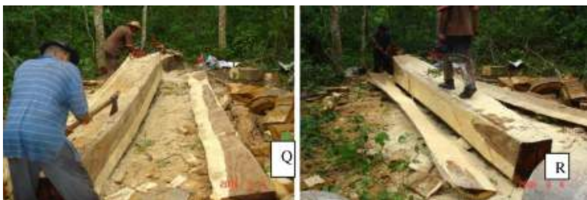
Figura 193 - preparação (esq.) e retirada (dir.) das laterais Fonte: Victorino (2013 [2006])
