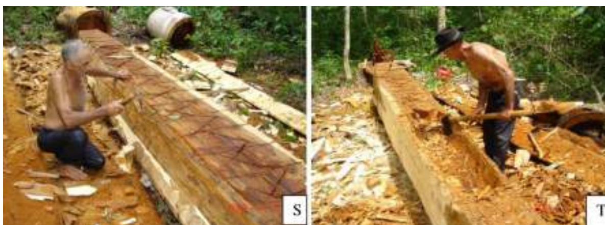
Figura 194 - Preparação para a limpeza (esq.); processo de “cavoucação” (dir.) Fonte: Victorino (2013 [2006])
