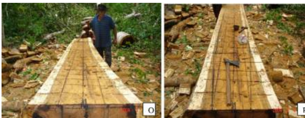
Figura 192 - Bateção das linhas do centro/prumo; bateção das linhas dos lados Fonte: Victorino (2013 [2006])
