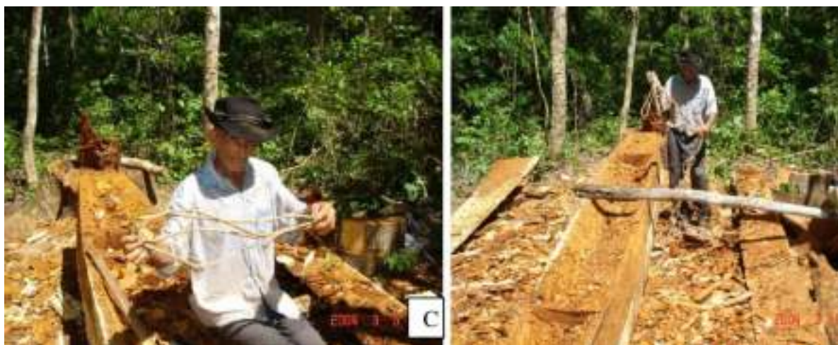
Figura 199 - Quarta medida do perímetro do tronco (esq.), Preparação para virada do tronco (dir.). Fonte: Victorino (2013 [2006])
