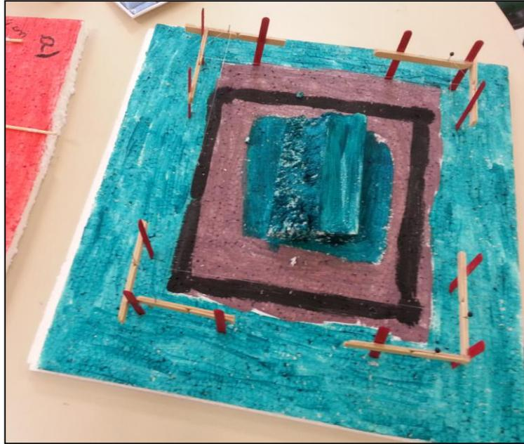
**Figura 20: Representação da demarcação inicial de uma obra. No detalhe, os gabaritos<sup>17</sup> nos cantos**
