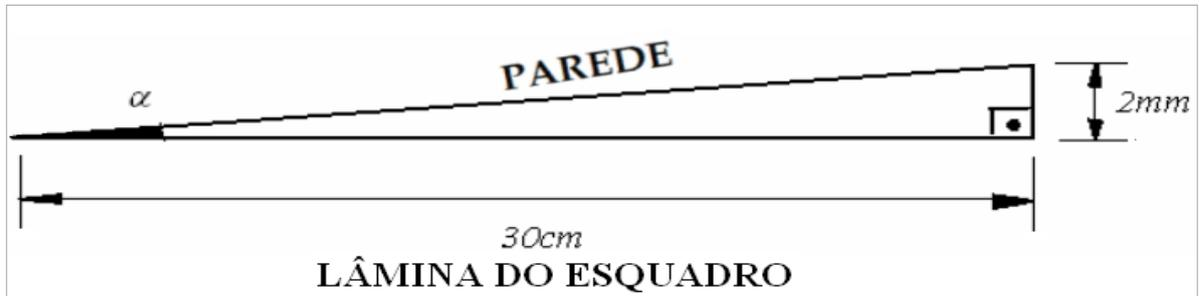
**Figura 22: Folga entre esquadro e parede: fora de escala para evidenciar o afastamento de 2mm. Fonte: o autor**
