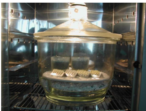
Figura 2 - Imagem do posicionamento de corpo de prova para metodologia de sorção e solubilidade.
