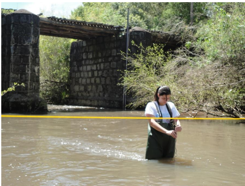
Figura 19 - Campanha hidrológica para determinação de descarga líquida usando micromolinete hidrométrico no arroio Cadeia
