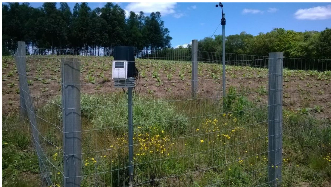
Figura 16 - Estação meteorológica, modelo Davis Vantage Pro2, localizada no município de Canguçu, Rio Grande do Sul
