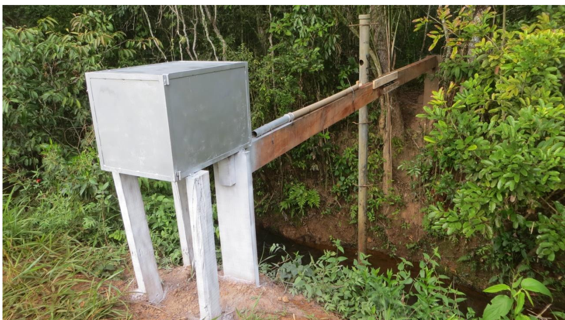
Figura 18 - Ilustração da seção de controle do ribeirão Jaguará com a estrutura para monitoramento automático de nível d'água e da unidade de aquisição e armazenamento de informações hidrológicas da mesma seção
