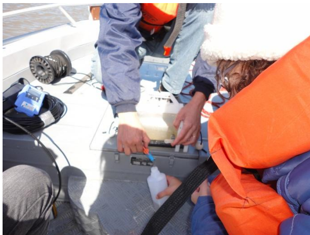
Figura 8 - Transferência de amostra para frasco PEAD.
