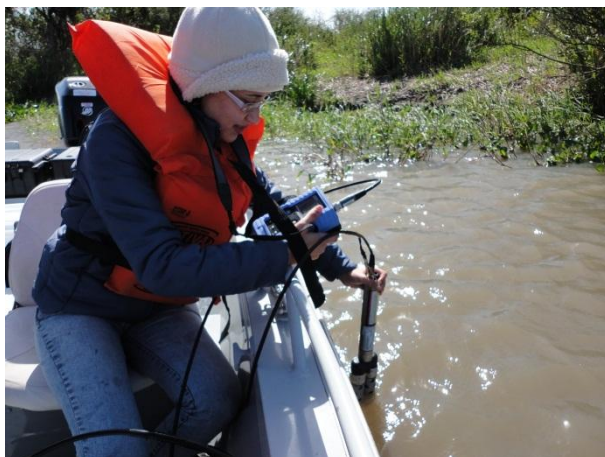
Figura 5 - Medição de parâmetros físico-químicos in situ .
