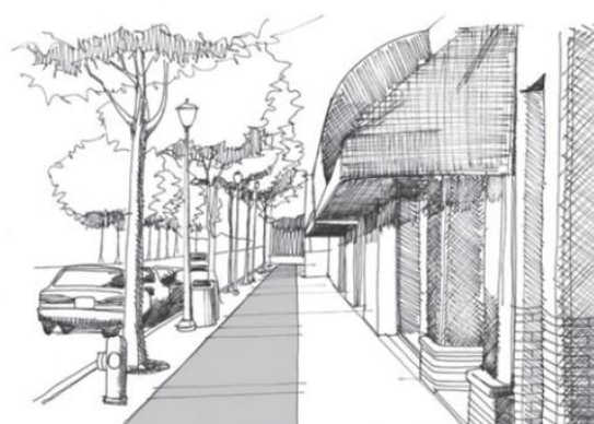
Figura 2.15: Setorização da calçada destacando área destinada à circulação de pessoas e área para implantação do mobiliário urbano (Fonte: Google, 2012).
