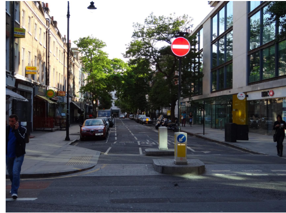
Figura 2.19: Desenho urbano utilizado para diminuir a velocidade dos veículos nas esquinas em Londres, Inglaterra (Fonte: Portella, 2012).
