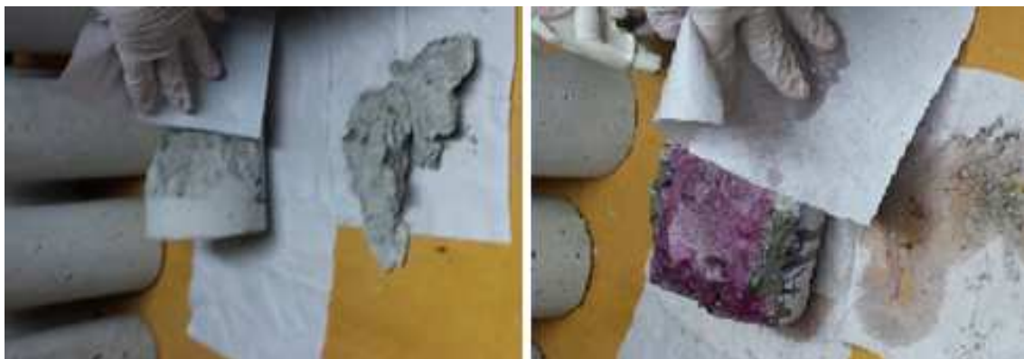
Figura 24 - Aspersão de nitrato de prata e fenolftaleína na face fraturada do corpo-de-prova.
