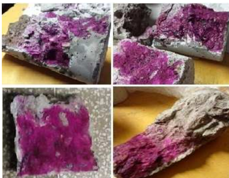
Figura 23 - Exemplo do aspecto das amostras após aspersão de fenolftaleína.
