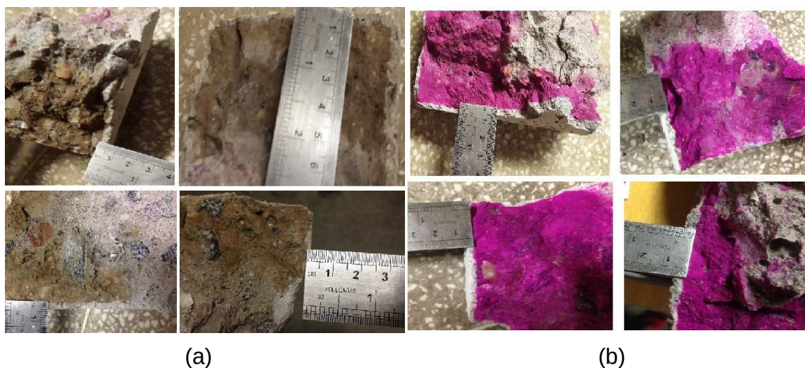
Figura 26 - Exemplo da medição da profundidade (a) de cloretos e (b) de carbonatação.
