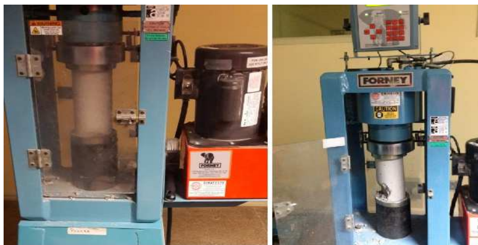
Figura 18 - Exemplo do rompimento do corpo-de-prova em prensa hidráulica.
