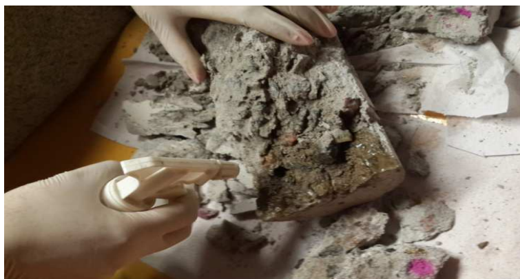
Figura 20 - Exemplo da aspersão de nitrato de prata na amostra fraturada.
