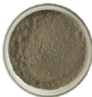
Figura 17 – Bio- \text{CaCO}_3 obtido por meio do método de calcinação.
