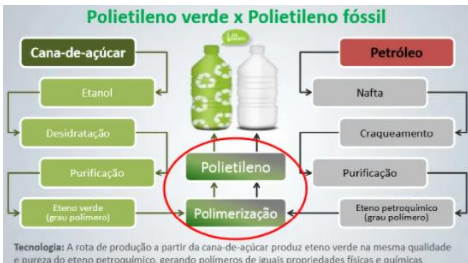
Figura 8 – Rota química do polietileno verde e polietileno convencional. Fonte: BETAEQ, 2015.
