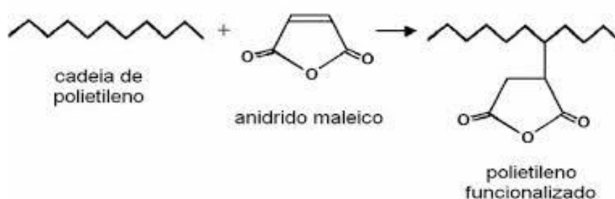
Figura 12 – Esquema reacional da graftização do polietileno com anidrido maleico (PE-g-AM). Fonte: BOSQUETTI, 2019, p. 32.
