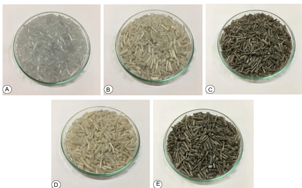
Figura 18 – Pellets obtidos pelo processo de extrusão, em A) PEVBD puro, B) PEVBD/ in natura , C) PEVBD/bio-CaCO 3 , D) PEVBD/ in natura /PE-g-AM, E) PEVBD/bio-CaCO 3 /PE-g-AM.
